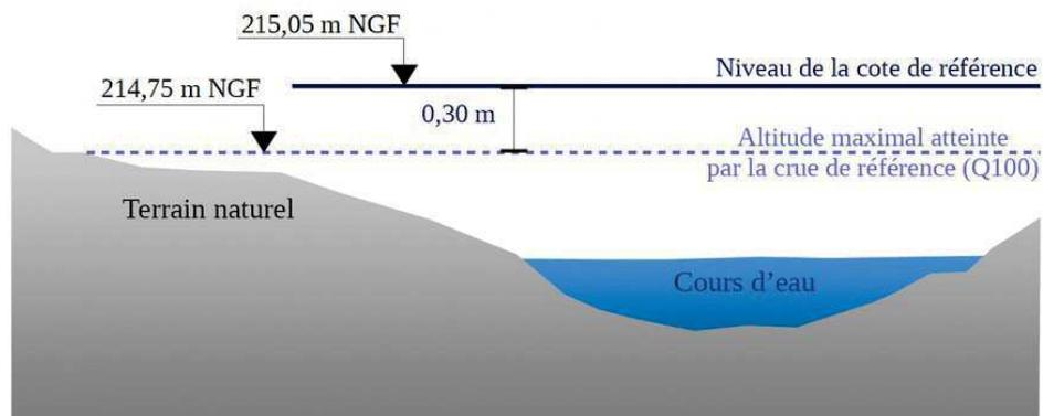
Les cotes de référence, matérialisées sur **les cartes réglementaires**, sont généralement associées à une ligne isocote. Lorsqu'un projet de construction se situe entre deux lignes isocotes, la cote de référence à prendre en compte doit être calculée par interpolation. Elle est calculée par rapport à la construction située le plus à l'amont selon la formule de calcul suivante :  $Cr = CAm - [(CAm - CAv) / (L2 + L1) \times L1]$
