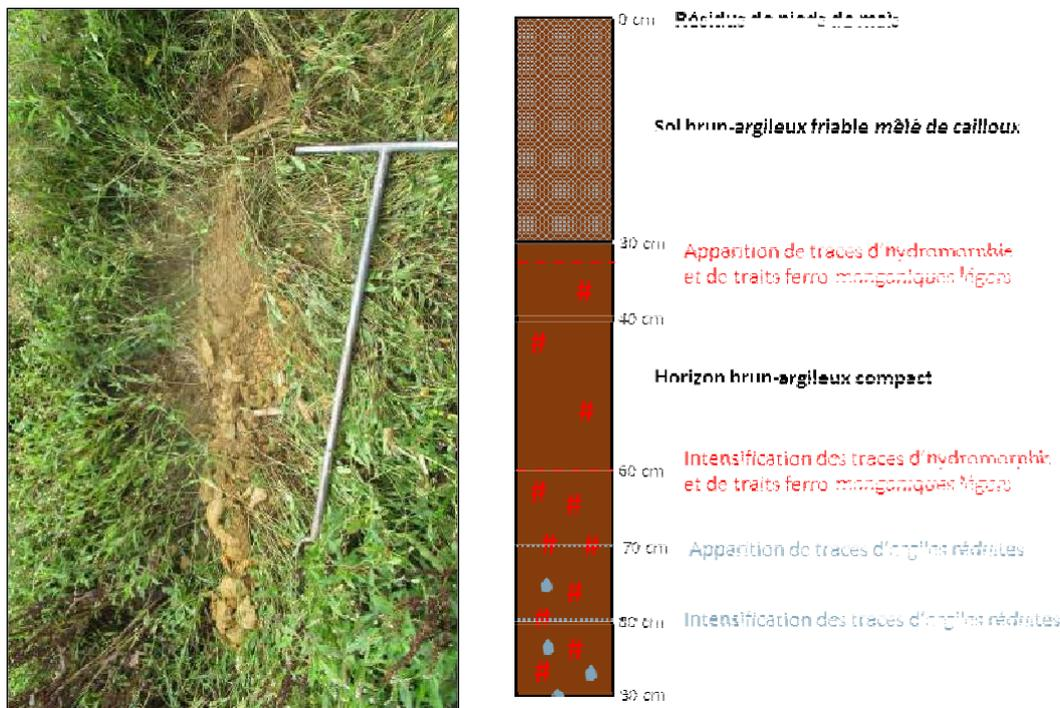
Des traces d'hydromorphie apparaissent dans les 40 premiers centimètres du sol et s'intensifient en profondeur avec la présence d'argiles réduites à partir de 70 cm. Si l'on se réfère aux classes d'hydromorphie du GEPPA (1981), ci-dessous, le sondage s'apparente au IVd, caractéristique des zones humides.
