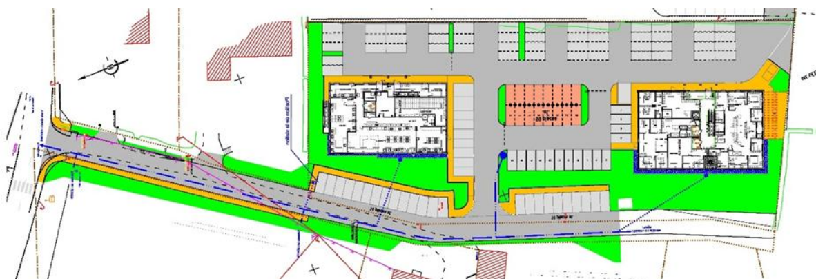
Plan montrant les réseaux d'adduction d'eau potable et l'implantation de l'attente et du compteur AEP au nord-ouest de la parcelle. Source : Aedefim Santé et Samazuzu.
