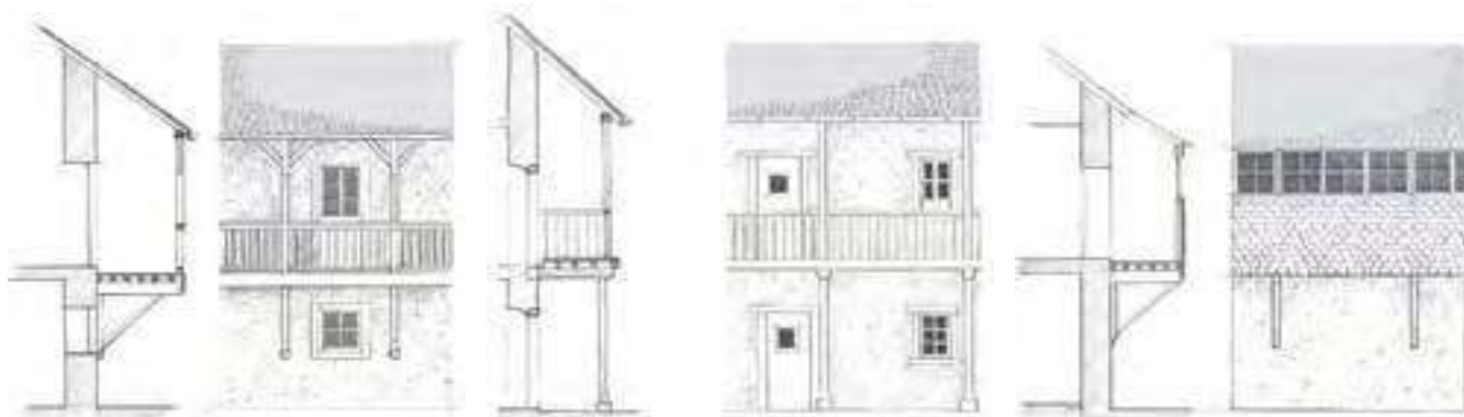
Galerie ouverte sur consoles.
