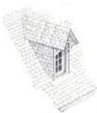
Lucarne à débord sur consoles.
