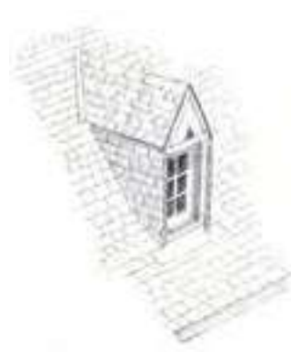
Lucarne en bâtière « jacobine ».
