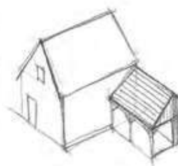
Abri léger orthogonal au bâti principal
