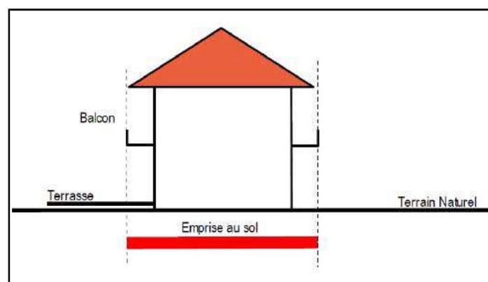
Schéma de principe d'emprise au sol
