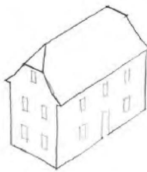
Maison à 2 niveaux, toiture simple à 2 pentes avec demi croupes.
