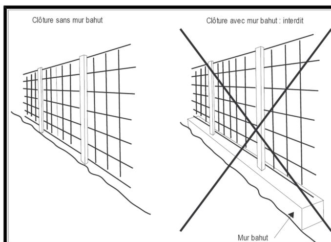
Mur de faible hauteur formant soubassement, surmonté d'un grillage. Ils sont interdits en zone inondable.
