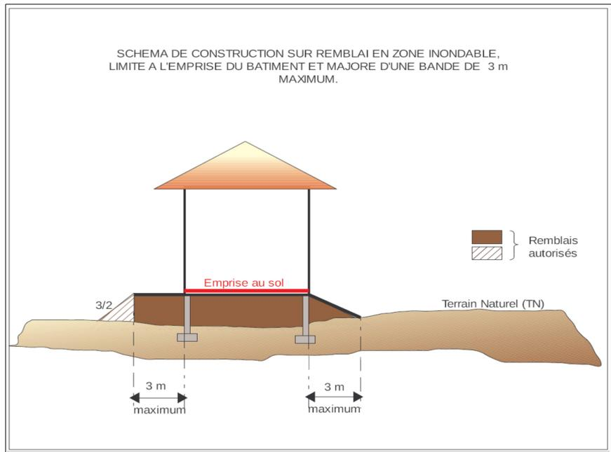
**2** Afin de limiter l'effet d'obstacle, la plus grande longueur du bâtiment doit être placée dans l'axe des écoulements de l'eau. On évitera les décrochements importants au niveau de l'emprise de la construction (voir schéma ci-dessous)
