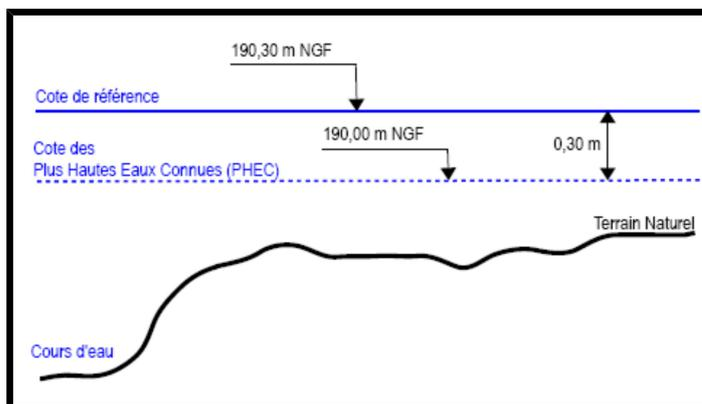
Les cotes de référence sont généralement associées à un profil en travers. Elles peuvent également être appliquées sur un secteur déterminé. Lorsqu'un projet de construction se situe entre deux profils en travers, la cote de référence à prendre en compte doit être calculée par extrapolation. Elle est calculée par rapport à l'angle de la construction située le plus à l'amont.
