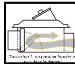
Ce clapet peut être installé facilement dans un regard existant d'eaux usées en amont du réseau. Le cas échéant, un tel regard sera à créer, avec un couvercle facilement repérable et accessible.
