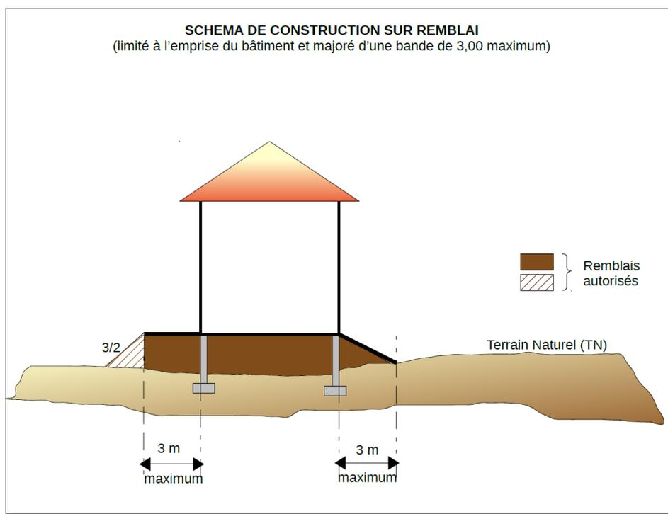
**A**fin de limiter l'effet d'obstacle, la plus grande longueur du bâtiment doit être placée dans l'axe des écoulements de l'eau. On évitera les décrochements importants au niveau de l'emprise de la construction (voir schéma ci-dessous)
