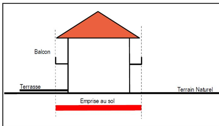
Schéma de principe d'emprise au sol
