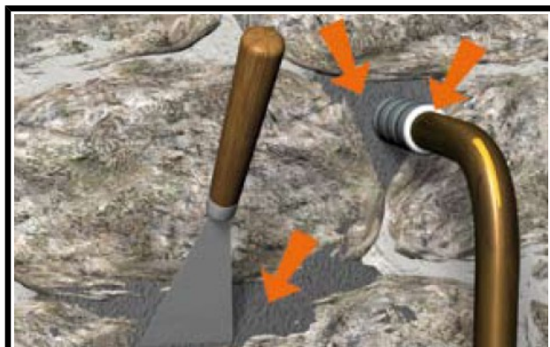
Situation après travaux de colmatage
